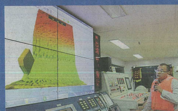
技術人員反覆多波束掃描監基槽回淤情況
